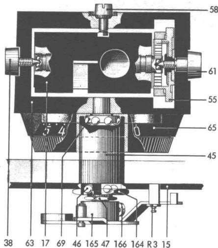
Fig. 6 Tonarmlagerung mit Antiskating-Einrichtung
