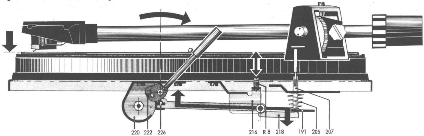
Die Höhe der Abtastnadel über der Schallplatte läßt sich durch Drehen der Stellschraube (R 8) im Bereich von 0–6 mm variieren. Durch Rechtsdrehen wird der Abstand
